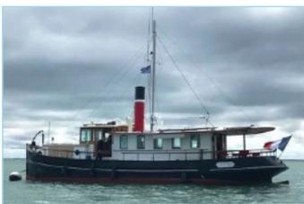
de restauration gigantesque sur les quais de Bordeaux, transformant la physionomie de *Hoop* en construisant la jolie cabine arrière actuelle, à l'endroit du pont de remorquage. La coque en acier riveté a été doublée, puis le *Kromhout* à bout de souffle changé pour un moteur de chalutier, un *Baudoin* de 450 chevaux. Douze mille heures de travail, durant plus de dix ans.
